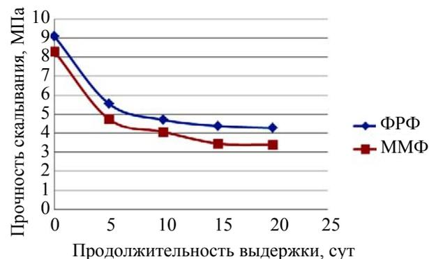
Рис. 2. Влияние воздействия воды на прочность клеевого соединения
