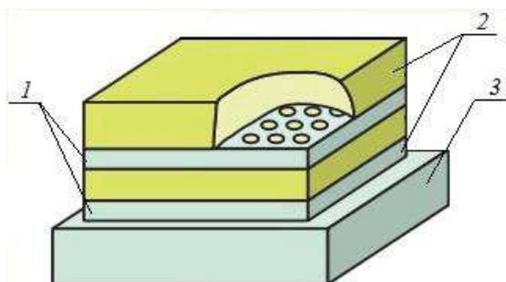
Рис. 2. Емкостный датчик относительной влажности:
