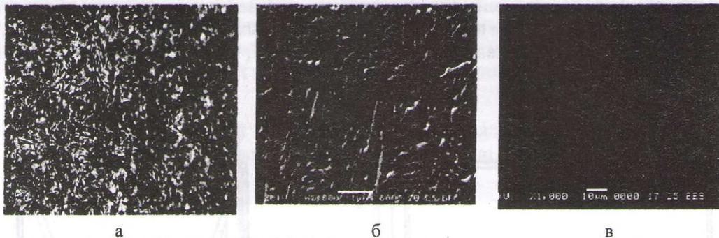
Пояснения: а – закалка в 0,8%-м растворе полимера,  $\times 500$ ; б – закалка в 0,8%-м растворе полимера,  $\times 2000$ ; в – закалка в 1,6%-м растворе полимера,  $\times 1000$  (исследования методом сканирующей электронной микроскопии).
