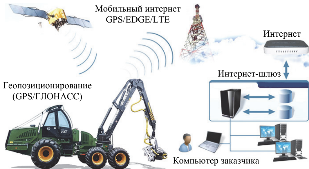
Рис. 1.3. Основные принципы геопозиционирования и передачи данных лесозаготовительных машин
