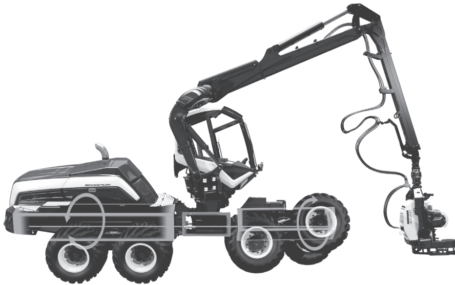
Рис. 2.45. Харвестер Ponsse Scorpion с трехмодульной конструкцией рамы и системой стабилизации положения кабины оператора на ее основе
