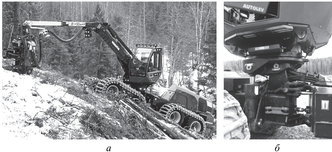
Рис. 2.43. Система Autolev в процессе работы: а – работа на уклоне; б – общий вид системы
