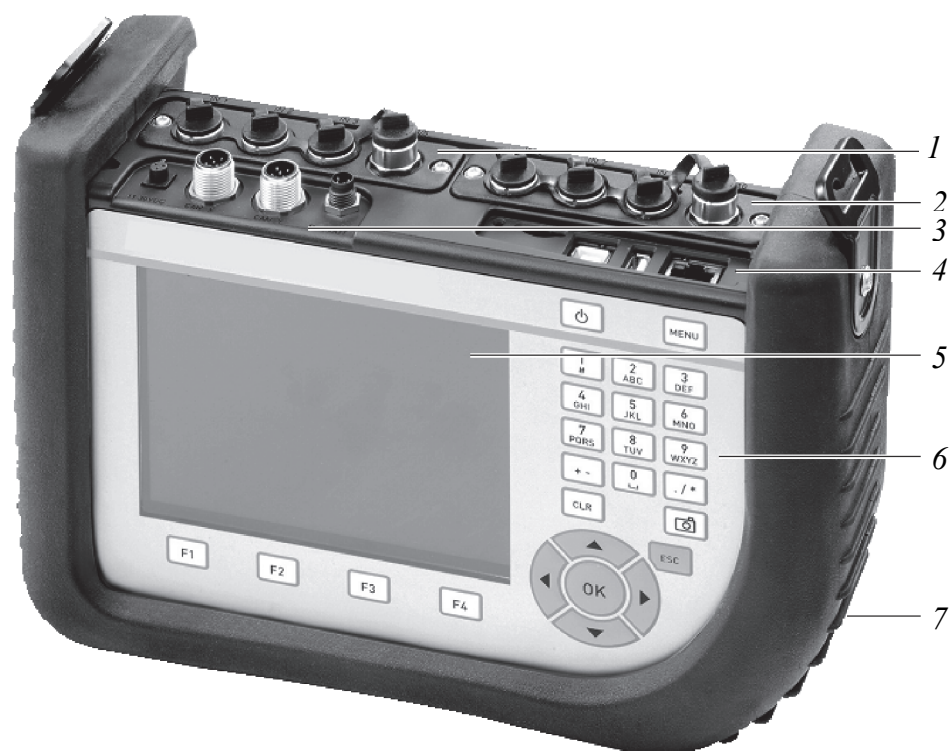
Рис. 2.32. Расположение основных внешних элементов прибора: 1 – входной модуль; 2 – дополнительный входной модуль (опциональный); 3 – вход и выходы на базовом приборе; 4 – порты связи; 5 – экран; 6 – клавиатура; 7 – защитный резиновый футляр для корпуса
