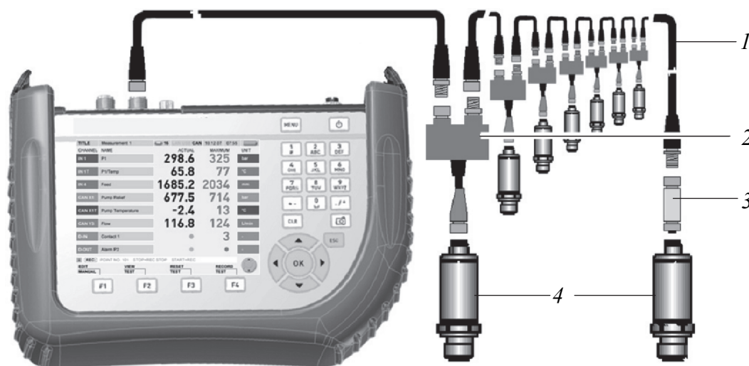
Рис. 2.34. Подключение датчиков к диагностическому прибору Parker Service Master Plus:
