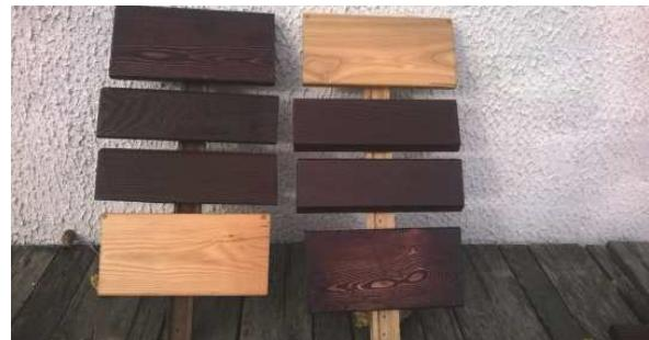
Рис. 2. Натурные испытания масляных покрытий
