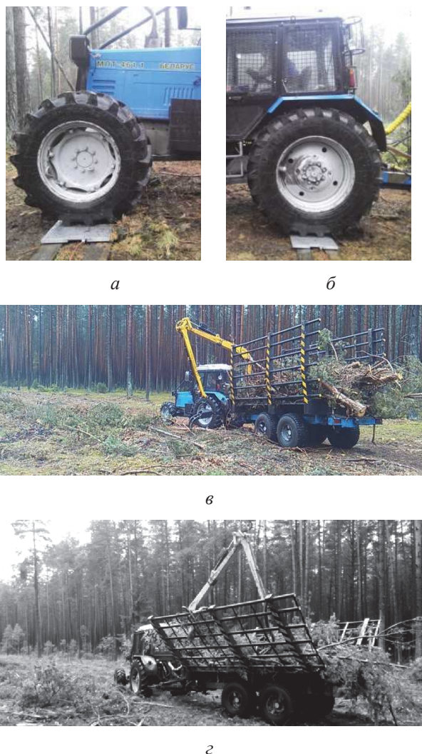
Рис. 4. Определение реакций под колесами машины для транспортировки лесосечных отходов: а – определение реакции под передней осью базового трактора; б – определение реакции под задней осью базового трактора; в – погрузка лесосечных отходов с закрытыми бортами; з – погрузка лесосечных отходов с открытыми бортами
