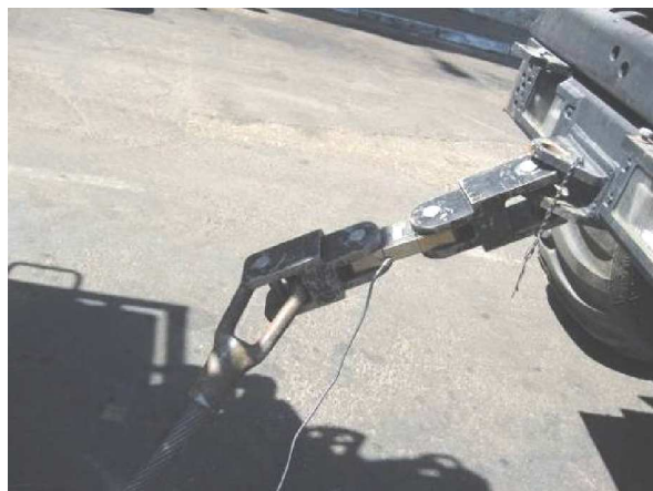
Рис. 7. Тензометрический датчик электронного динамометра ДОР-3-И-200
