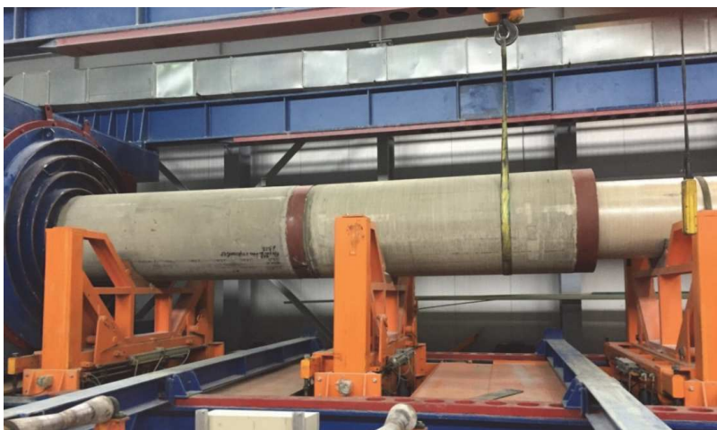
Рисунок 2. Испытание труб гидростатическим давлением
