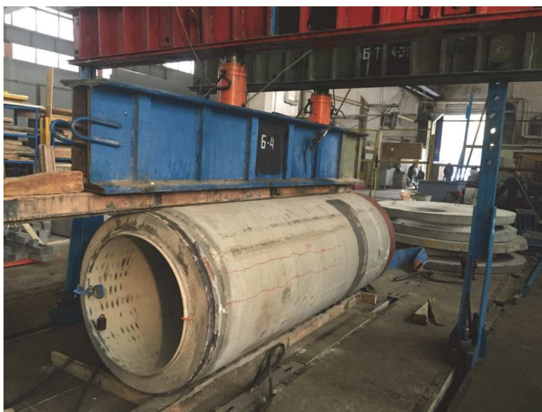
Рисунок 3. Испытание трубы трехлинейной нагрузкой
