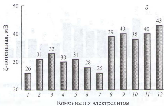
Рис. 3. Зависимость \xi -потенциала от вида и содержания индивидуальных (а) и комбинированных электролитов (б) □ — Na 5 P 3 O 10 ; ■ — Na 2 CO 3 ; ● — Na 2 O · 2,8SiO 2 , ▲ — УЩР; остальные обозначения те же, что на рис. 2
