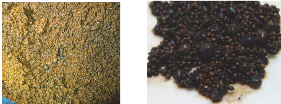
Рис.1. Зерна фильтрующей загрузки, покрытые продуктами биоокисления железа и марганца
