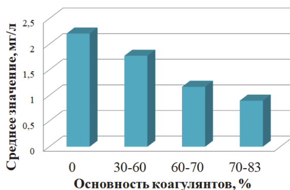
Рисунок 3. Содержание остаточного алюминия в пробах осветленной воды
