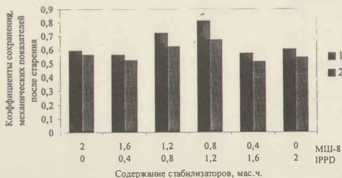
Рис. 1. Зависимость коэффициентов сохранения механических показателей наполненных вулканизатов на основе НК+СКМС-30АРКМ-15 от соотношения компонентов внутри комбинации IPPD+МШ-8 (1 — по условной прочности при растяжении; 2 — по относительному удлинению при разрыве)
