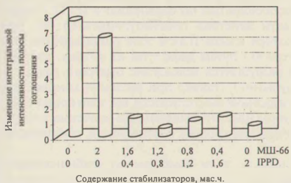
Рис. 3. Изменение интегральной интенсивности поглощения в ИК спектре в области частот 1540\text{ см}^{-1}
