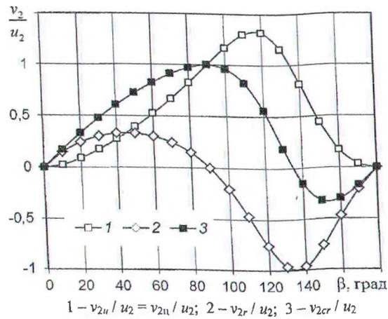
Рисунок 1 - Зависимость отношения скоростей от угла наклона лопастей
