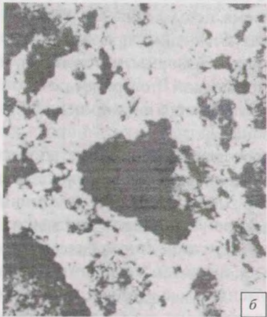
Рис. 1. Структура теплоизоляционного материала, полученного способами пенообразования (а) и газообразования (б)
