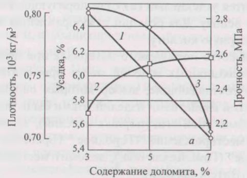
Рис. 2. Зависимость плотности (1), пористости (2) и усадки (3) пеноматериала от содержания пены
