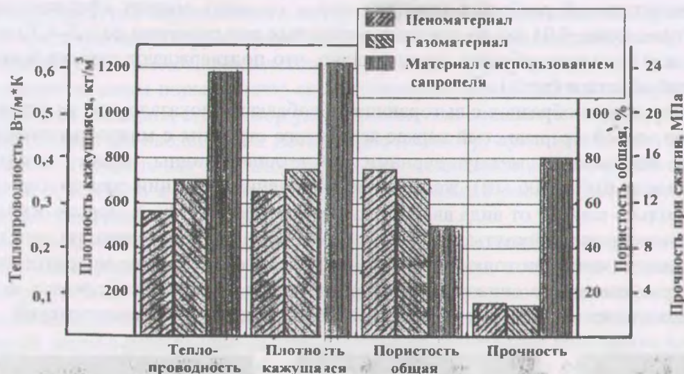
Рис. 2. Гистограммы зависимости свойств синтезированных материалов от метода поризации
