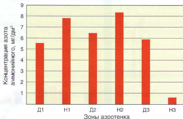
Рис. 3. Изменение концентрации азота аммонийного по зонам аэротенка при реализации варианта 2
