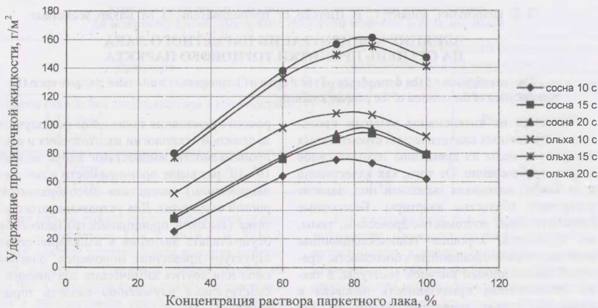
Рис. Зависимость удержания пропиточной жидкости (степени пропитки) от концентрации раствора паркетного лака
