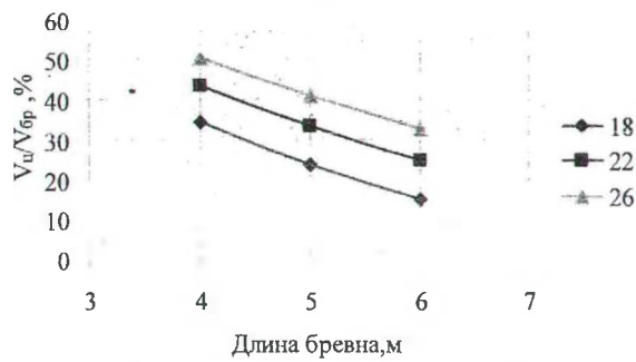
Рис. 4. Зависимость процента цилиндрической зоны от исходной длины бревна при K=1,2 и f=2\%
