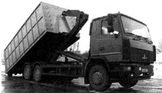
Рис. 5. Топливозов с системой мультилифт
