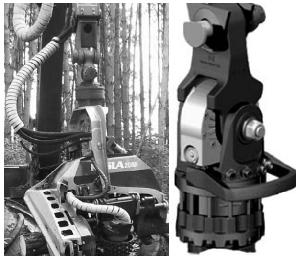
Рис. 2. Гаситель колебаний рабочего органа
