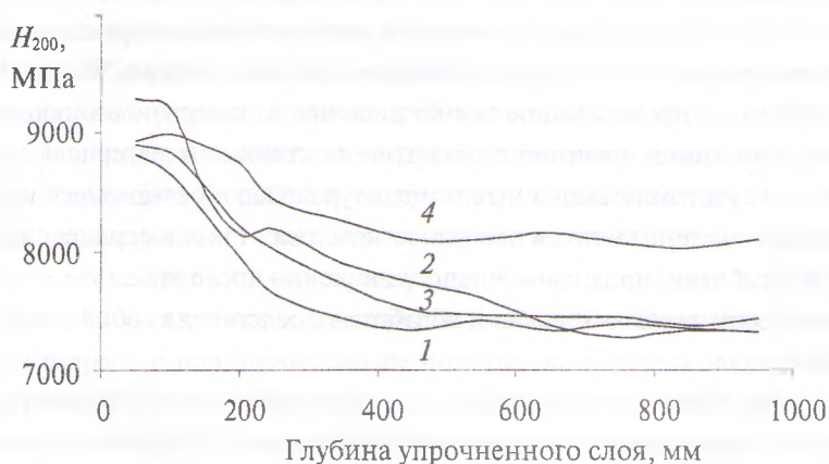
Рис. 1. Распределение микротвёрдости H_{200} по сечению образцов стали Х12М упрочнение которых проводили в течение 90 часов перед закалкой с различных температур. Температура закалки: 1 — 1060 °C; 2 — 1080 °C; 3 — 1100 °C; 4 — 1130 °C
