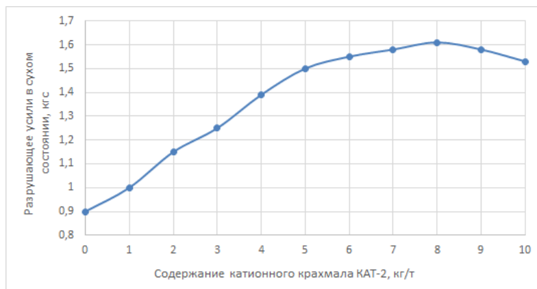
Рисунок 1 – Влияние катионного крахмала КАТ-2 на разрушающее усилие в сухом состоянии
