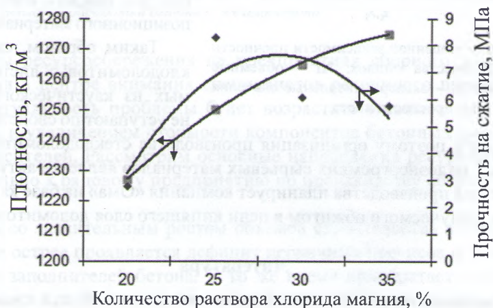
Рис. 3. Зависимость прочности и плотности образцов стеклодоломитового листа от количества раствора хлорида магния
