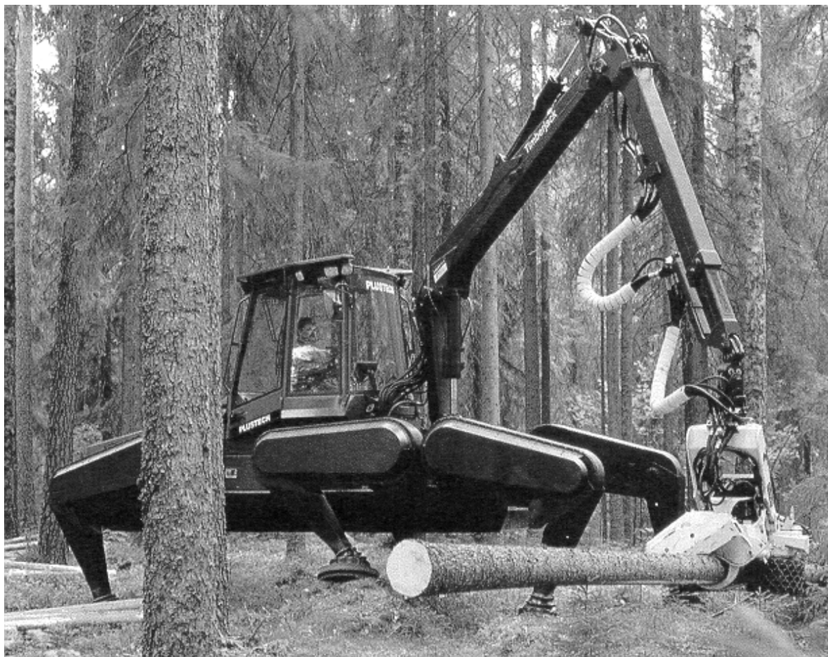
Рис. 7. Лесная машина с шагающим движителем
