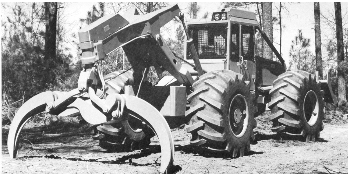
Рис. 5. Колесный трелевочный трактор со специальными лесными шинами
