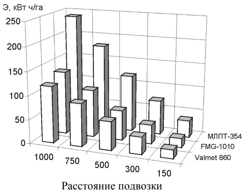
Рис. 91. Энергоемкость процесса подвозки древесины
