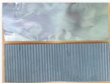
Рисунок 1 – а – гладкая фольга; б – гофрированная фольга
