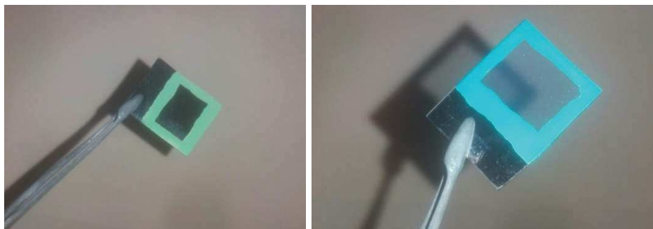
Рисунок 2 – Натриевые стекла (а – до анодирования, б – после анодирования в щавелевой кислоте)
