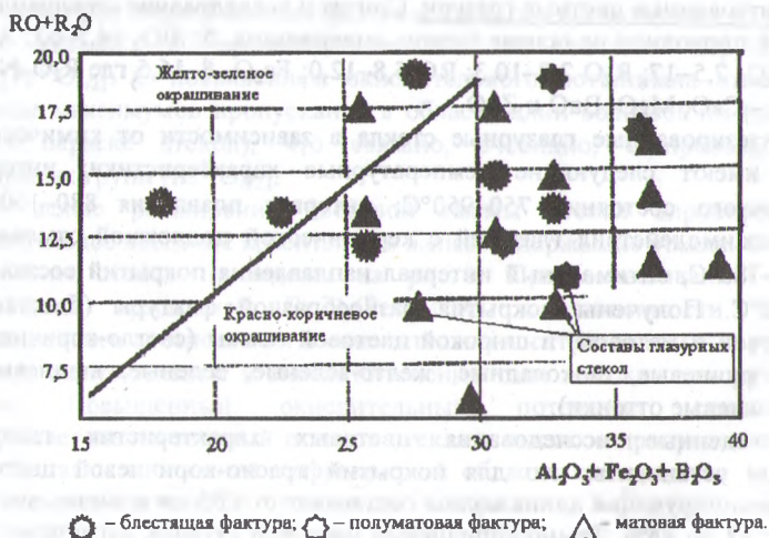
Рис. 2. Качественная оценка и положение экспериментальных составов стекол в системе координат (R_2O+RO) - (Al_2O_3+B_2O_3+Fe_2O_3)
