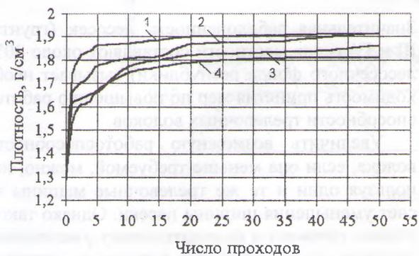
Рис. Плотность грунта в зависимости от нагрузки и числа проходов: 1 — нагрузка 3200 кг; 2 — 2500 кг; 3 — 2500 кг с укреплением волока сучьями; 4 — 2000 кг
