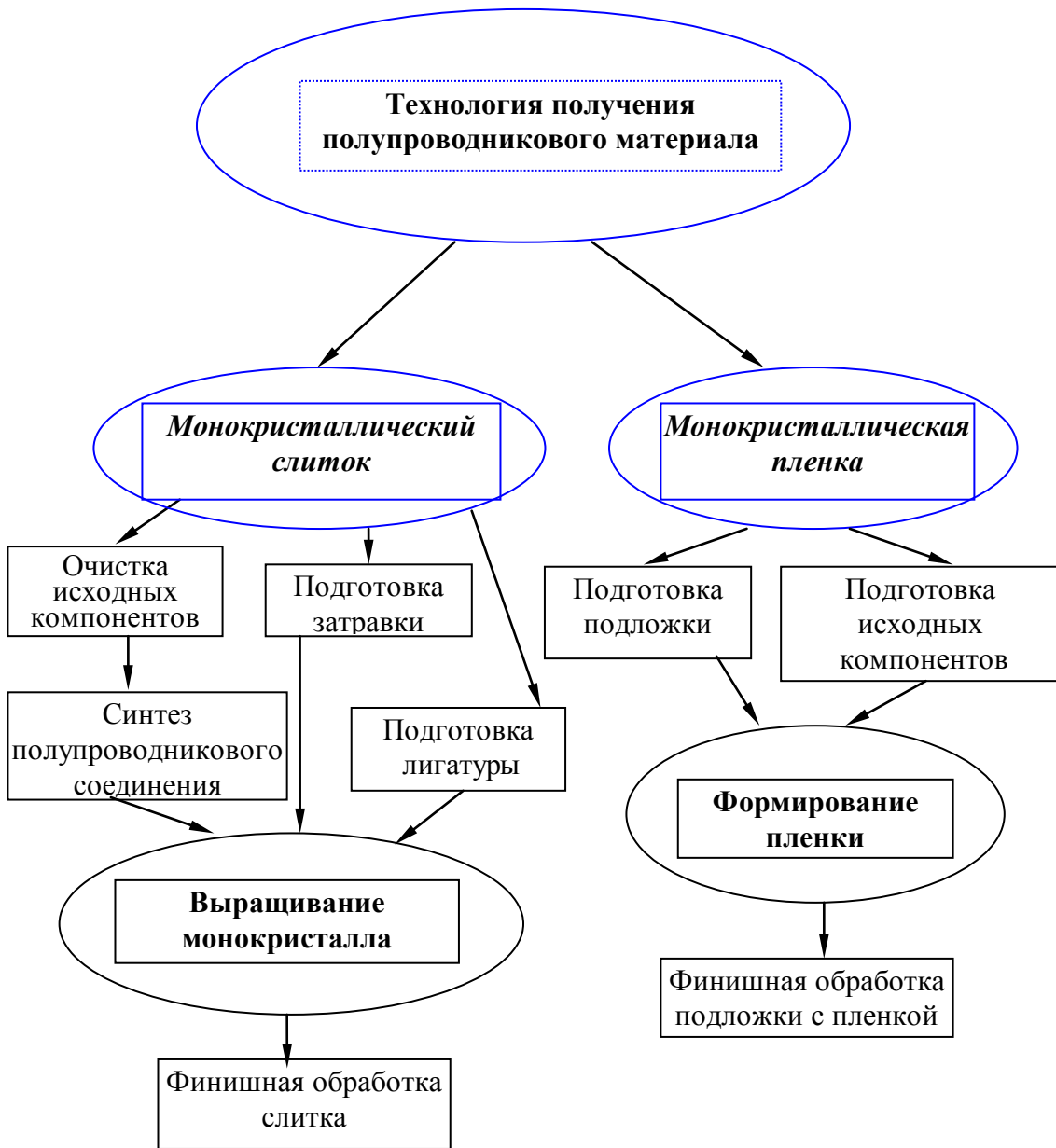
Рис. 2. 2. Блок-схемы маршрутов производства полупроводников
