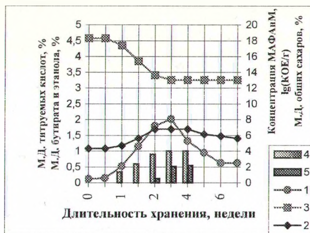
Рис. 1. Динамика роста V. casegans и изменения физико-химических свойств пищевого продукта в процессе хранения при температуре 20 \pm 2^\circ\text{C}
