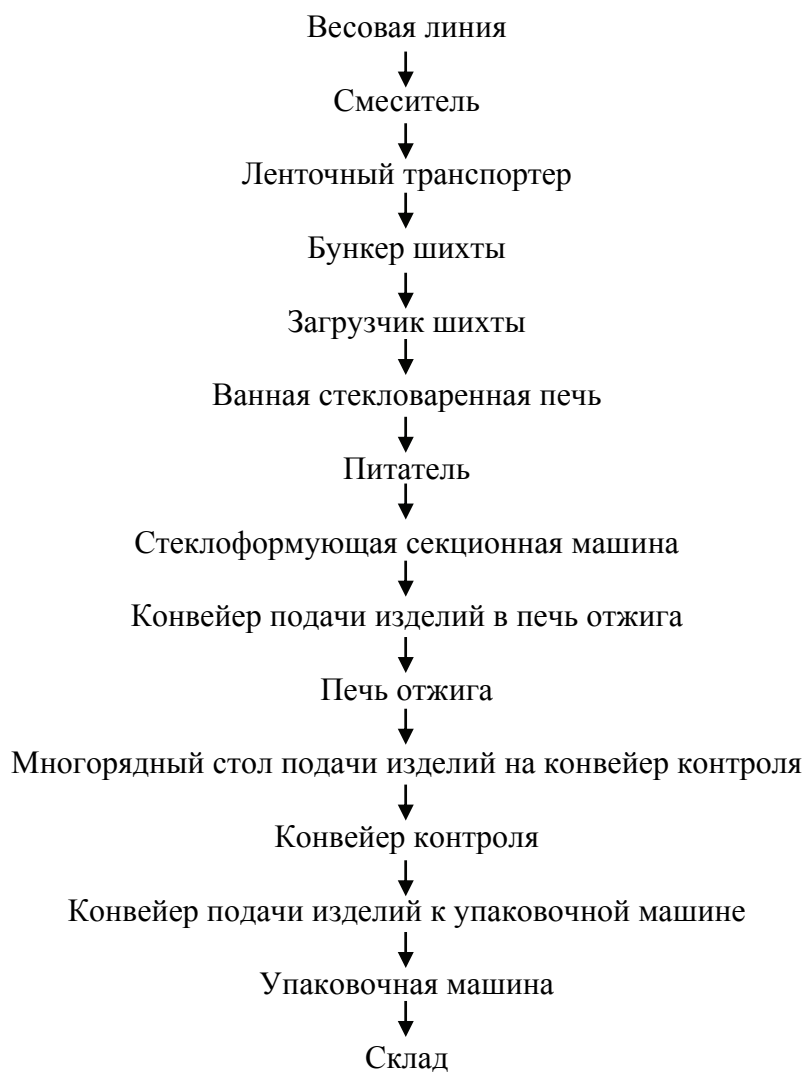
Рис. Е.2. Технологическая схема производства стеклотары
