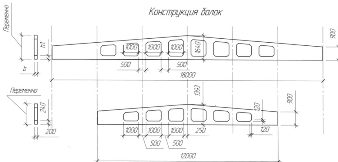
Рис. 2.8. Конструкция балок скатных покрытий пролетом 12 и 18 м
