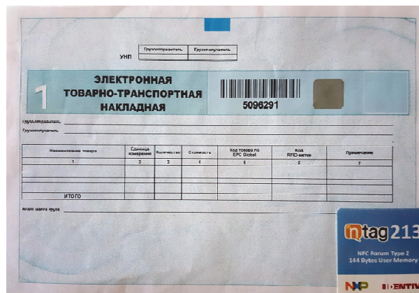
Рис. 3. ТТН с RFID-меткой
