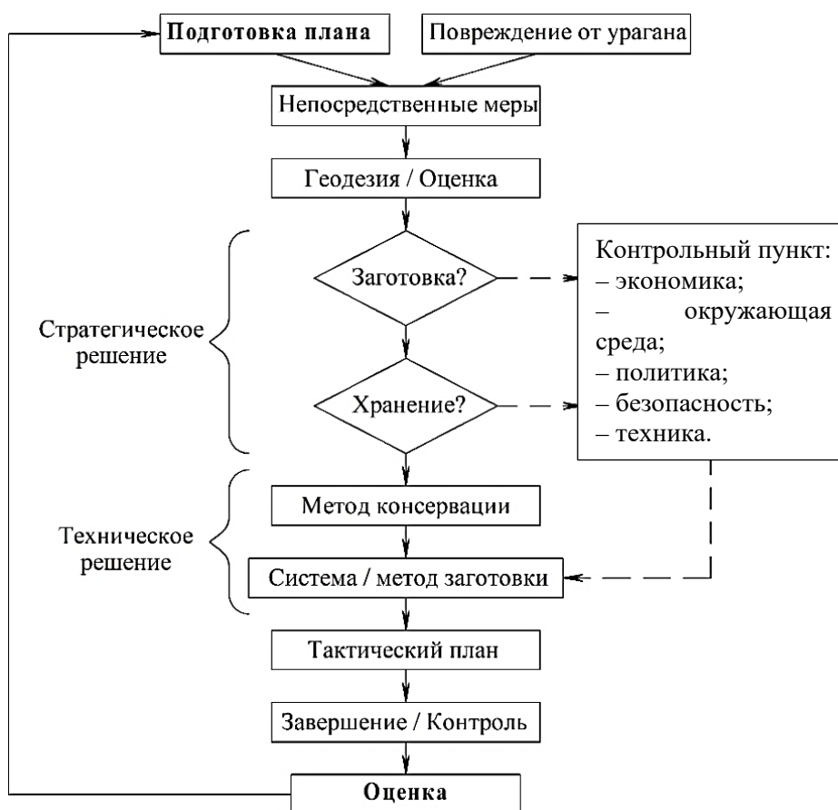
Рисунок 7 – Схема принятия решений по лесозаготовкам и сохранению лесоматериалов после урагана
