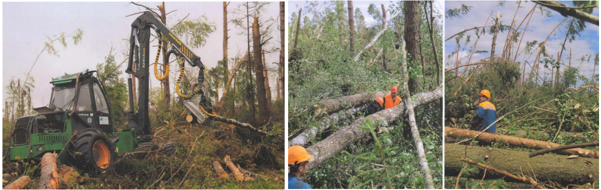
Рисунок 19 – Разработка ветровальных лесосек: а – с использованием многооперационной техники, б – с использованием бензиномоторных пил
