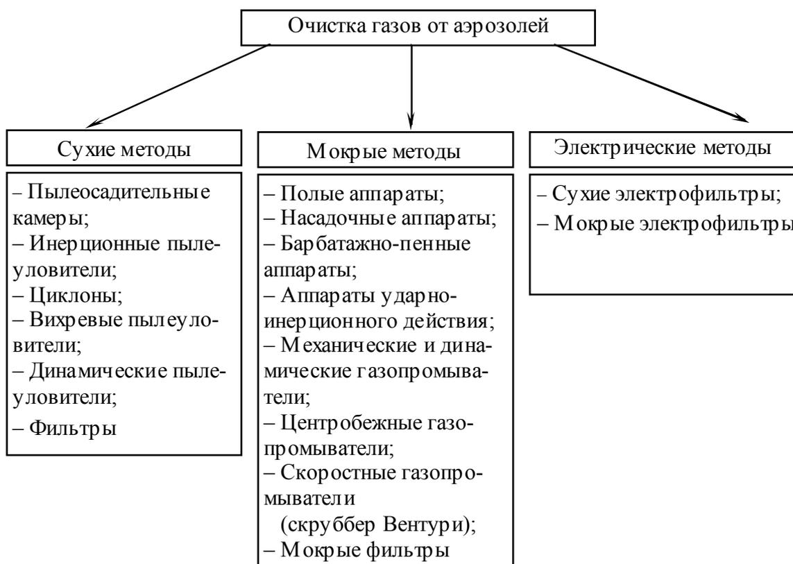
Рис. 1. Классификация методов очистки газовойоздушных выбросов от аэрозолей
