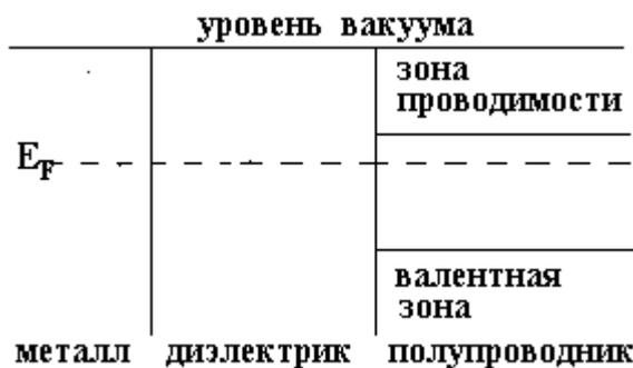
Рис.10.5. Энергетическая диаграмма МДП-структуры в тепловом равновесии.
