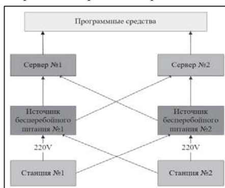
Рис. 1. Схема системи безперебійного живлення
