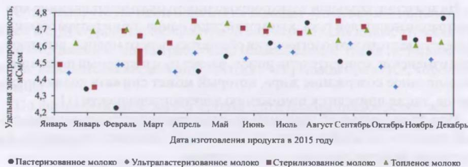
Рис. 2. Изменения средних значений электропроводности термически обработанного молока разных производителей в 2015 году
