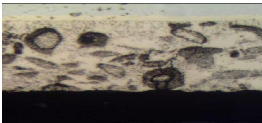
Рисунок 2 – Микрофотография поперечного среза покрытия, полученного из суспензии, стабилизированной катионным и неионогенным ПАВ. Режим электролиза: i = 1 \text{ А/дм}^2 , \tau = 60 \text{ мин} , t = 25^\circ \text{С} .
