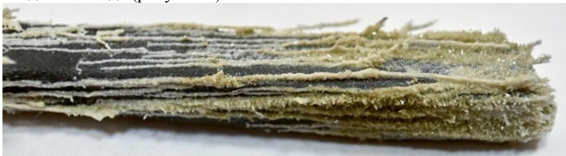
Рисунок 4 – Общий вид ренийевого анода, покрытого солевым осадком
