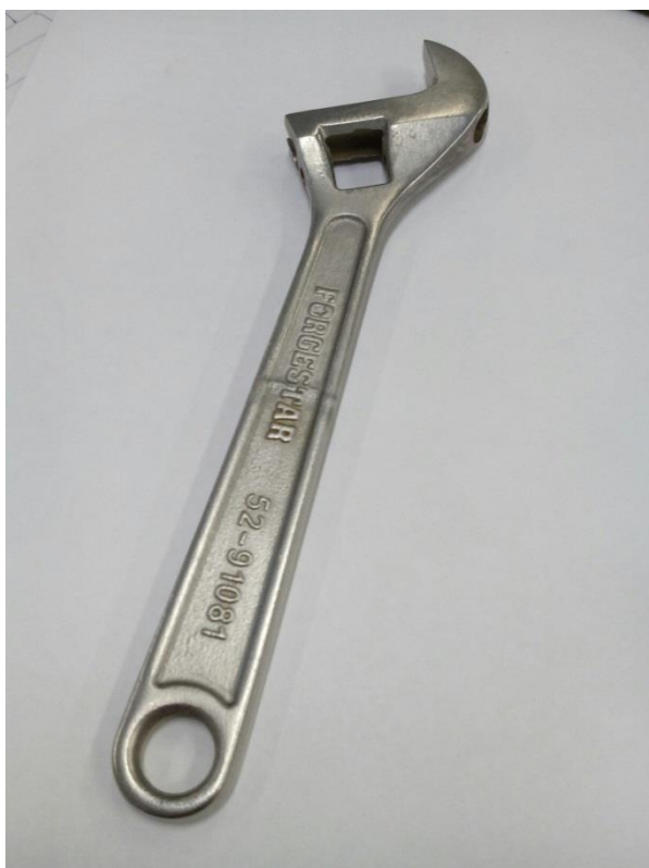
Рисунок 1 – Результат электрохимического полирования изделия из конструкционной легированной стали 40ХФА электролите на основе органического растворителя
