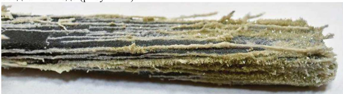
**Рисунок 4 – Общий вид ренийевого анода, покрытого солевым осадком**
