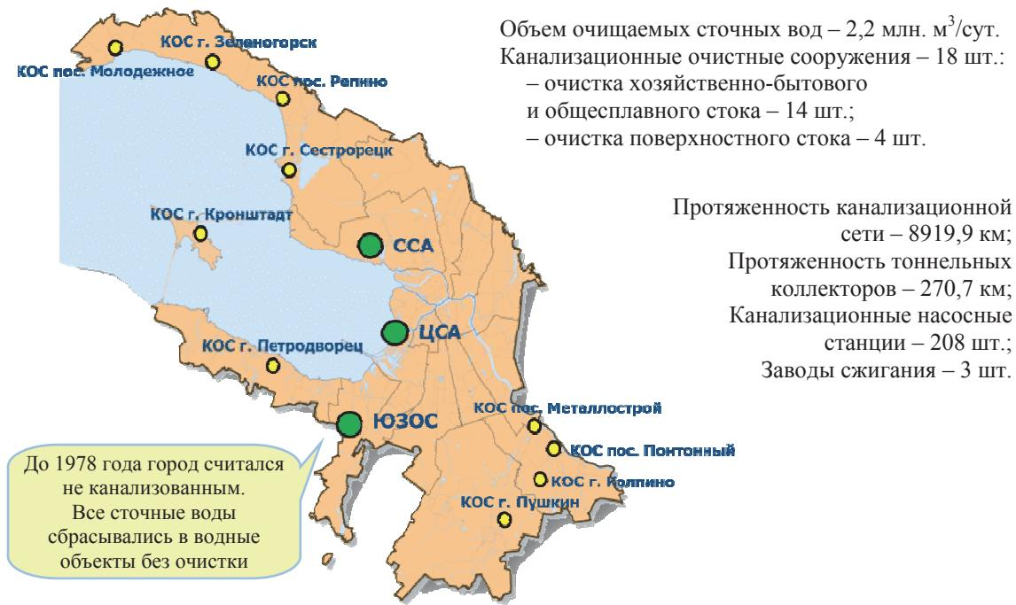
На всех канализационных очистных сооружениях в технологической схеме сточные воды проходят механическую и биологическую очистку, а также обработку реагентом для удаления фосфора фосфатов.
