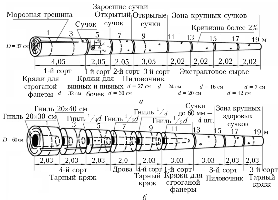
Рис. 54. Примеры раскряжевки хлыстов дуба: а – раскряжевка дубового хлыста при наличии заросших и наружных сучков, морозной трещины и кривизны; б – раскряжевка дубового хлыста, пораженного напенной и стволовой гнилями, при наличии кривизны и сучков
