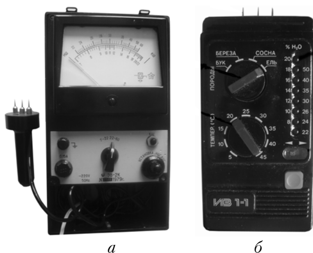
Рис. 17. Вид электровлагомеров ЭВ-2К (а) и ИВ1-1 (б)
