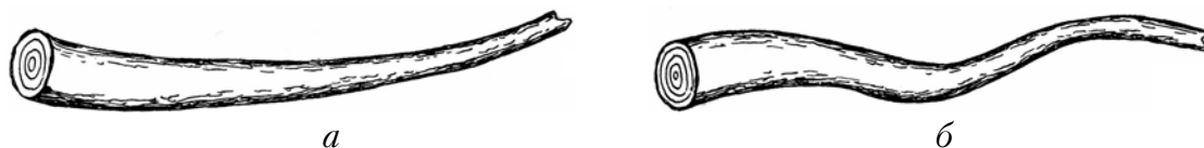
Рис. 43. Виды кривизны: а — простая; б — сложная
