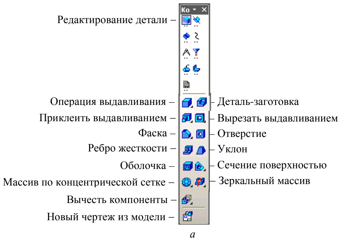
Рис. 7. Компактная панель системы КОМПАС-3D при создании и редактировании трехмерной модели детали: а – редактирование детали; б – вспомогательная геометрия; в – поверхности; г – пространственные кривые; д – измерения (3D); е – фильтры; ж – условные обозначения; з – элементы листового тела (см. также с. 17–19)
