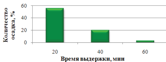
Рисунок – Влияние времени выдержки при T = 900^\circ\text{C} на количество нерастворившегося осадка
