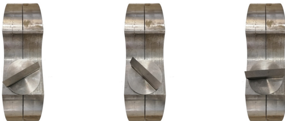
Рис. 5. Изменения угловых параметров фрезы
