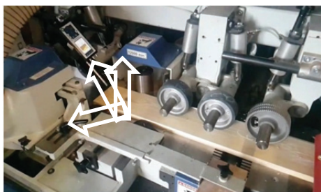
Рис. 2. Способ измерения звуковых волн (обозначены стрелками) при резании древесины
