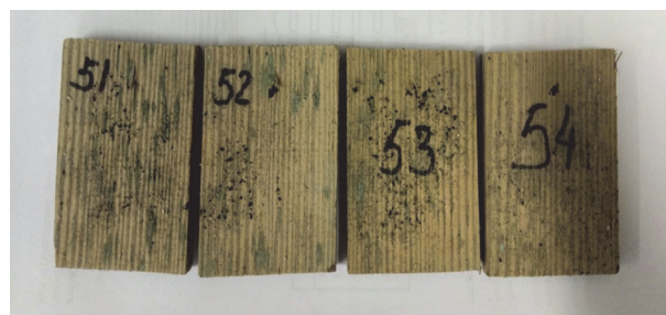
Рис. 4. Образцы после искусственного старения, срок эксплуатации – 2 года
