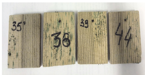
Рис. 3. Образцы после искусственного старения, срок эксплуатации – 1 год
