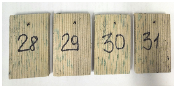
Рис. 2. Образцы после искусственного старения, срок эксплуатации – 6 месяцев
