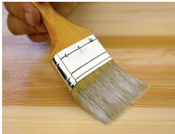
Рис. 1. Нанесение лакокрасочного состава на образцы кистью
