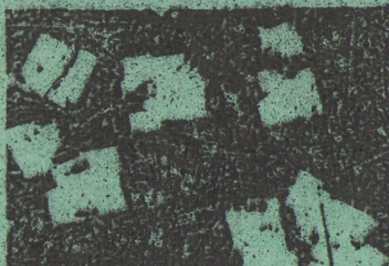
Рис. 35. Микроструктура баббита В16 (светлые полиэдры \beta -фазы (Sn Sb) и иглы \alpha на фоне эвтектики [ \alpha (Pb) + \beta (Sn Sb)])
